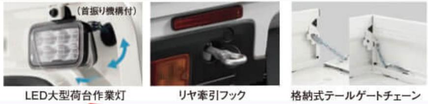
LED大型荷台作業灯 (首振り機構付) リヤ牽引フック 格納式テールゲートチェーン
